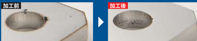
SUS t12.0 レーザークット サンドイニングシート + 研磨ブラシ
